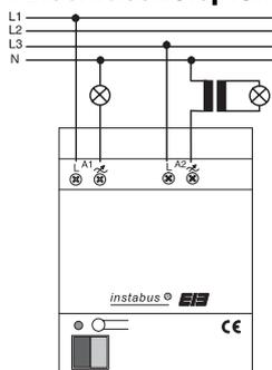
Der Anschluss verschiedener Außenleiter an A1 und A2 sowie zeitgleicher Betrieb von kapazitiven oder ohmschen Lasten z. B. an Kanal 1 und induktiven Lasten an Kanal 2 ist möglich.
