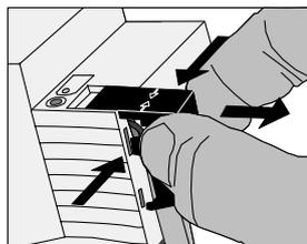
Die Abdeckkappe mit nach unten herausgeführten Busleitungen über die Busklemme schieben (Abb. Ⓐ) bis sie spürbar einrastet. Entfernen Sie die Abdeckkappe durch seitliches Drücken und Abziehen (Abb. Ⓑ).
