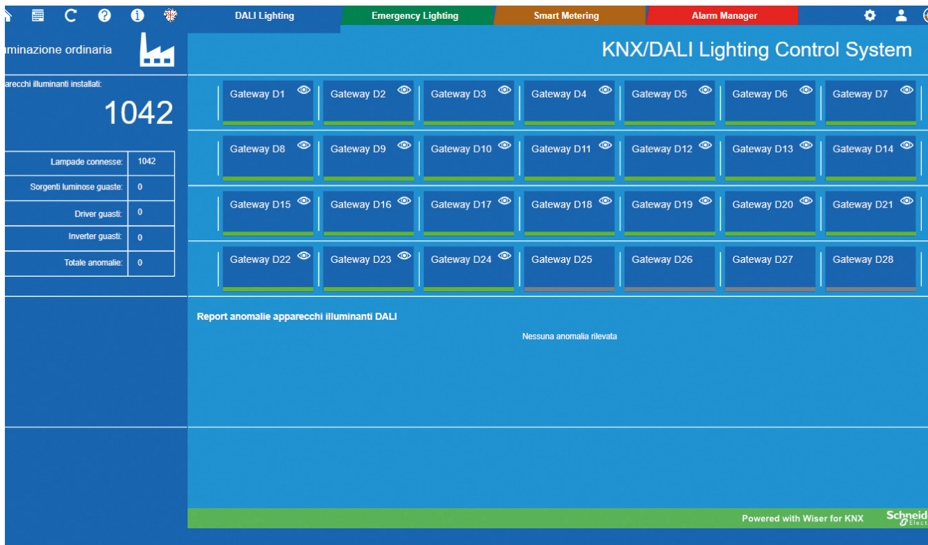
Abb. 62. Anwendungsbeispiel für die Anzeige von DALI-Diagnosedaten
