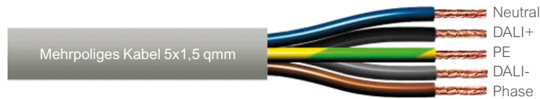
Abb. 37. Stromverteilung und DALI-Bus in einem mehradrigen Kabel
