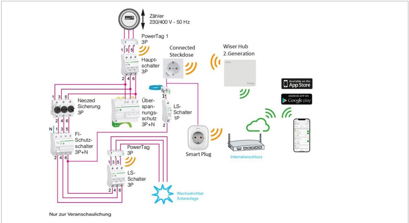
Die Resi9 Power Tags, montiert im Zählerschrank über den Leitungsschutzschaltern des Wechselrichters, werden über ZigBee mit dem Wisernetz Hub verbunden und lassen sich so über die Wiser Home App auslesen und auswerten. Die PowerTags lassen sich unter anderem auch bei bestehenden Automaten flexibel nachrüsten.
