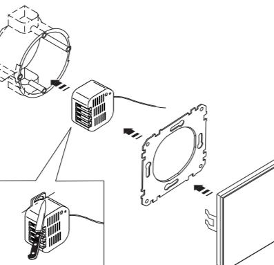
**i** Die Antenne möglichst weit entfernt von metallischen Teilen (Anschlussleitungen, Tragringe etc.) verlegen, um Störungen des Funksignals zu vermeiden.
