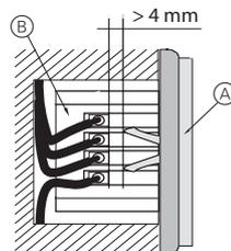
Ist der Abstand kleiner als 4 mm muß eine tiefere Installationsdose verwendet werden!
