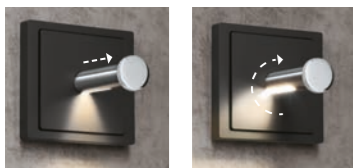
qles Licht-Stick: Halter und Lampe in einem. Beim Herausziehen schaltet sich das Licht ein und lässt sich schwenken.
