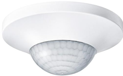
Anwesenheitserkennung im Innenbereich. Erkennt der KNX ARGUS Präsenz kleinere Bewegungen im Raum werden Datentelegramme über KNX gesendet, um gleichzeitig z. B. Beleuchtung, Jalousie oder Heizung zu steuern. Bei der helligkeitsabhängigen Bewegungserkennung für die Beleuchtungssteuerung überprüft das Gerät ständig die Helligkeit im Raum. Ist ausreichend natürliches Licht vorhanden, schaltet das Gerät das Kunstlicht trotz einer anwesenden Person aus. Die Nachlaufzeit ist über die ETS einstellbar.
