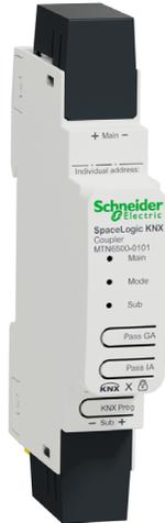
Der KNX-Koppler ist erforderlich für die logische Verbindung und galvanische Trennung von KNX-Linien und -Bereichen. Das Gerät unterstützt KNX Security. Diese Option kann durch die Software ETS aktiviert werden. Als sicherer Linienkoppler ermöglicht das Gerät die Weiterleitung von gesicherter und ungesicherter Kommunikation. Zusätzlich ist der Zugriff auf das Gerät selbst (z .B. für einen Download) durch KNX Security geschützt.
