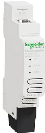
Das Spacelogic KNX/IP Interface ist eine Schnittstelle zwischen IP und KNX. Man kann von jedem Punkt des LAN-Netzes auf den Bus zugreifen. Das Spacelogic KNX IP Interface kann als Programmierschnittstelle für die ETS 5 Software verwendet werden und ermöglicht den Zugriff auf den KNX-Bus über das Internet über ein VPN. Das Gerät unterstützt KNX Security. Diese Option kann durch die Software ETS aktiviert werden.
