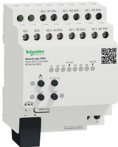
Zur Ansteuerung von elektrothermischen Ventiltrieben für Heiz- oder Kühldecken. Der Ventiltriebsregler hat 6 elektronische Ausgänge. An jeden Ausgang können bis zu 4 Ventiltriebe angeschlossen werden. Die Ausgänge sind entweder schalterbetätigt (1 Bit) oder PWM-Signal (1 Byte) aktiviert. Jeder Ausgang ist überlast- und kurzschlussgeschützt. Alle Ausgänge können manuell per Tastenbedienung bedient werden. Zusätzlich enthält der Ventiltriebsregler 6 integrierte Raumtemperaturregler (RTR).
