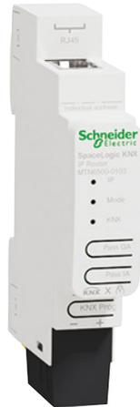
Der SpaceLogic KNX/IP-Router ermöglicht die Weiterleitung von Telegrammen zwischen verschiedenen Linien über ein LAN (IP) als schnellen Backbone. Das Gerät kann zusätzlich als Kommunikationsschnittstelle verwendet werden, um einen PC an den KNX-Bus anzuschließen (z. B. für die Programmierung mit der ETS-Software oder eConfigure KNX).
