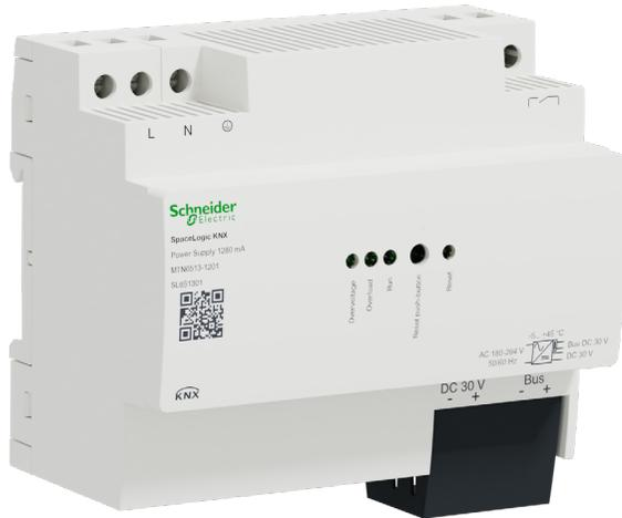
Das Stromversorgung SpaceLogic KNX erzeugt die Busspannung für die KNX-Leitung. Die Stromversorgung hat zwei Ausgänge: einen KNX-Ausgang mit integrierter Induktivität und einen 30 V DC-Ausgang für Zusatzgeräte.
