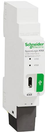
Zum Anschluss eines Programmier- oder Diagnosegerätes mit einer USB-Schnittstelle an den KNX. Der USB-Stecker (Typ C) ist vom KNX-Bus galvanisch getrennt. Er kann als Programmierschnittstelle für die ETS Software Version 4 (oder höher) verwendet werden. Das Gerät wird lokal mit der physikalischen Adresse programmiert und verfügt über keine Programmier-LED. Mit 2 Status-LEDs.
