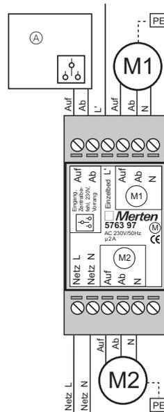
Ⓐ Eingang Zentralbefehl Steuerspannung 230 V, Vorrang
