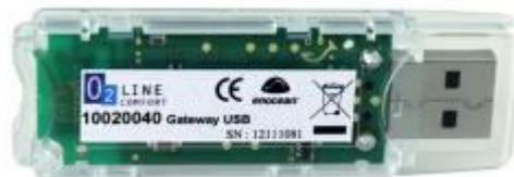
Bei diesem USB-Gateway handelt es sich um einen kleinen USB-Stick, der PCs, Verbrauchergeräte, DSL-Boxen und andere USB-Mastergeräte mit Funkprodukten von EnOcean verbindet. Er ist mit einem TCM 310 Empfänger-Gateway-Modul ausgestattet und stellt eine bidirektionale EnOcean-Funkschnittstelle sowie eine bidirektionale serielle Schnittstelle über USB bereit. Funknachrichten werden über einen extern verbundenen USB-Host gesendet und empfangen.
