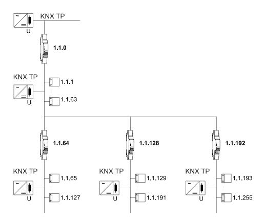
Der KNX-Koppler kann auch als Repeater eingesetzt werden. In diesem Fall hat die einzelne Adresse das Format x.y.z, wobei z nicht gleich 0 sein darf. Die Filtereinstellungen im Parameterdialog des ETS sind im Repeatermodus nicht wirksam.
