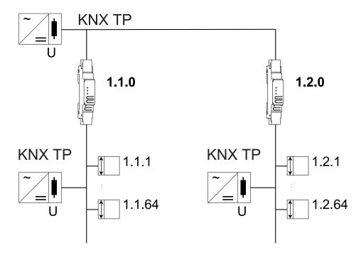
Wenn die physikalische Adresse die Form x.y.0 (x, y: 1...15) hat, funktioniert der Router als Linienkoppler. Wenn sie die Form x.0.0 (x: 1...15) hat, fungiert der -Koppler als Backbone-Koppler.
