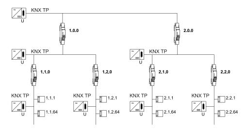
Der KNX Koppler verfügt über eine Filtertabelle und trägt so zur Reduzierung der Buslast bei. Die Filtertabelle (8 kB) unterstützt den erweiterten Gruppenadressbereich (Hauptgruppen 0 bis 31) und wird automatisch vom ETS generiert.
