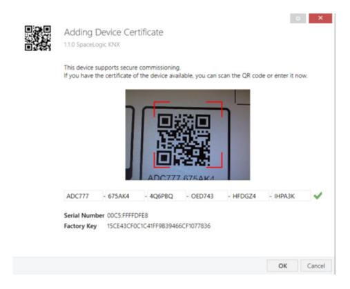
Das Zertifikat wird als Text auf dem Gerät gedruckt. Es kann auch bequem vom gedruckten QR-Code aus über eine Kamera gescannt werden, die mit dem PC verbunden ist, auf dem das ETS läuft.
