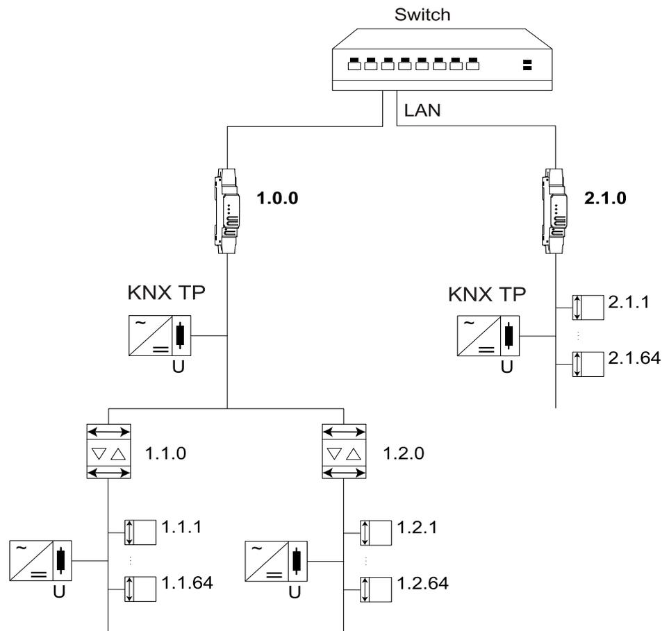
Der KNX IP Router verfügt über eine Filtertabelle und trägt so zur Reduzierung der Buslast bei. Die Filtertabelle (8 kB) unterstützt den erweiterten Gruppenadressbereich (Hauptgruppen 0 bis 31) und wird automatisch vom ETS generiert.
