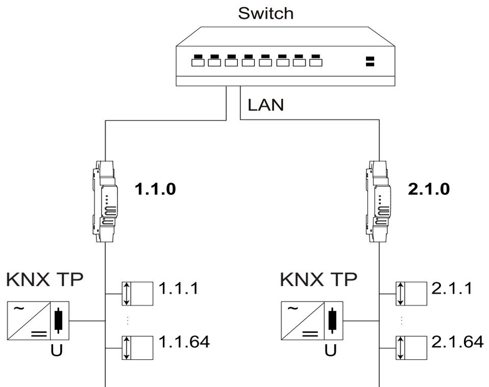
Wenn die physikalische Adresse die Form  $x.y.0$  ( $x, y: 1 \dots 15$ ) hat, funktioniert der Router als Linienskoppler. Wenn sie die Form  $x.0.0$  ( $x: 1 \dots 15$ ) hat, fungiert der Router als Backbone-Koppler.
