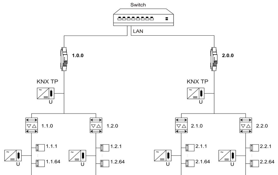
Wenn der KNX IP Router als Bereichskoppler (x.0.0) verwendet wird, darf in der darunter liegenden Topologie kein KNX IP Router vorhanden sein. Wenn ein KNX IP Router beispielsweise die physikalische Adresse 1.0.0 hat, darf kein KNX IP Router mit der Adresse 1.1.0 vorhanden sein.
