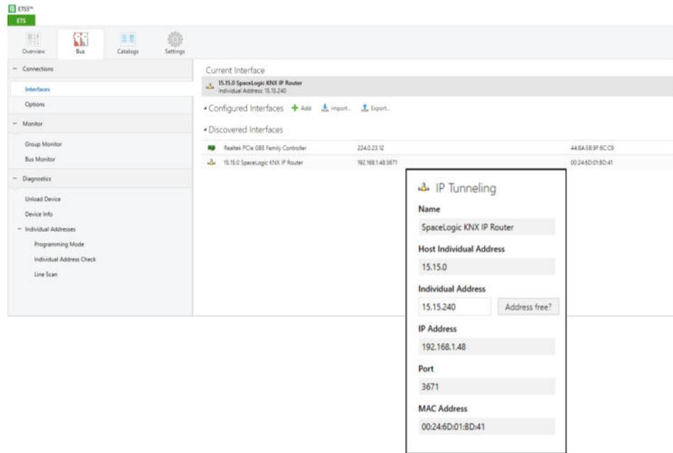
Die physikalische KNX-Geräteadresse und die physikalischen KNX-Adressen für zusätzliche Tunneling-Verbindungen können innerhalb des ETS-Projekts geändert werden, nachdem das Gerät dem Projekt hinzugefügt wurde.
