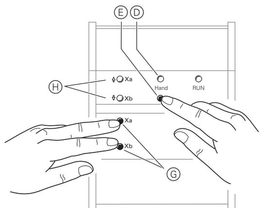
Nach 3 s blinkt die Handbetriebs-LED **(D)** und die Kanalstatus-LEDs **(H)** zeigen den Zustand der Kanäle an:
