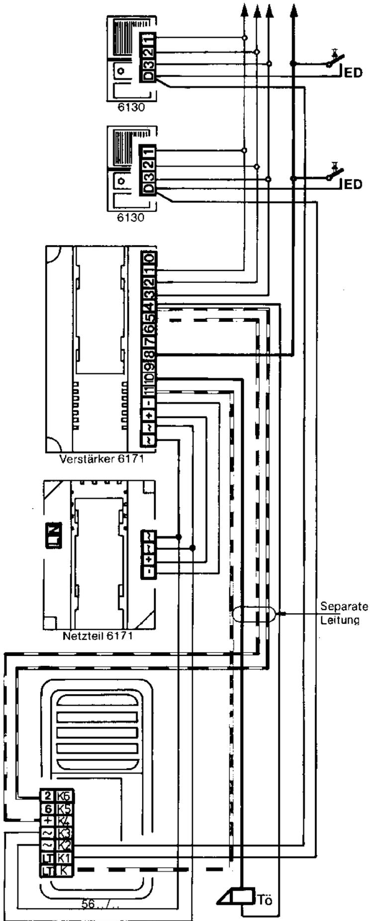
Anlage mit Tonruf von der Türstation (Tongenerator 6990 oder 6991 erforderlich)
