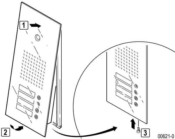
Die Glas-Türstation mit der Schraube im Montagekasten sichern.
