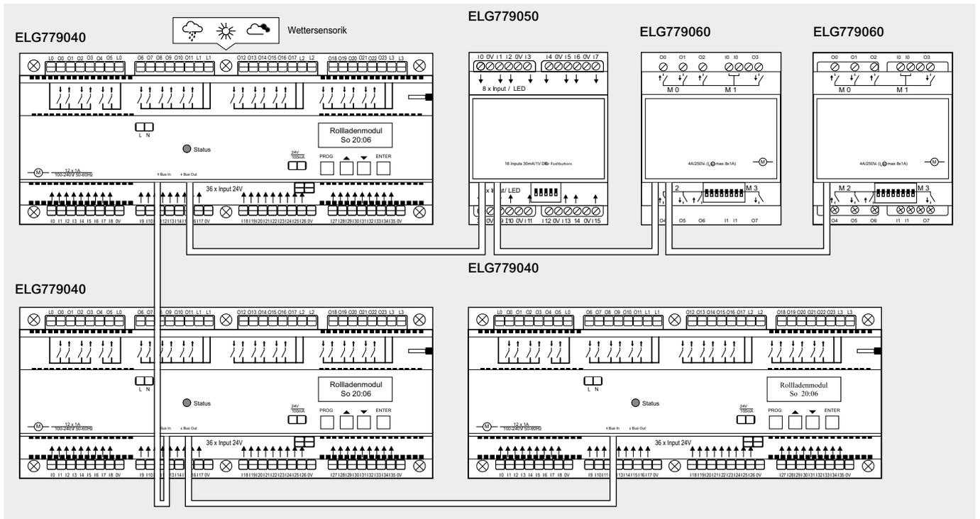
An das ELSO EHC Rollladenmodul lassen sich zwei weitere Rollladenmodule über die Bus-Leitung anschließen. Zusätzliche Erweiterungsmodule Ein- und Ausgang lassen sich nur an das Mastermodul anschließen. Damit ist eine maximale Anzahl von 44 Antrieben über das System steuerbar. Die an das Mastermodul angeschlossene Wettersensork wirkt dann auf alle angeschlossenen Antriebe entsprechend der im Mastermodul erfolgten Programmierung.
