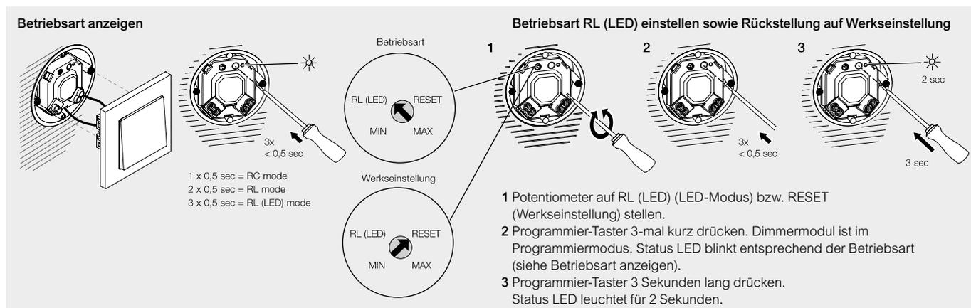
Programmier-Taster 3-mal kurz drücken. Status LED zeigt die aktuelle Betriebsart an. Sie blinkt je nach Betriebsart 1–3 mal kurz auf. Dimmermodul ist ausgeschaltet und Leitungsschutzschalter ist eingeschaltet. (Arbeiten unter Spannung!)
