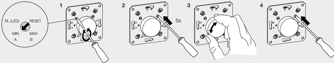
1 Potentiometer auf MINA/MAXB stellen. 2 Mikro-Taster 5 Sekunden lang drücken. (Die Lampe blitzt kurz auf.) 3 Drehknopf bis zur gewünschten minimalen / maximalen Helligkeit drehen. 4 Mikro-Taster kurz drücken. Die eingestellte Helligkeit wird als minimale/ maximale Helligkeit gespeichert und der Einstellmodus beendet.
