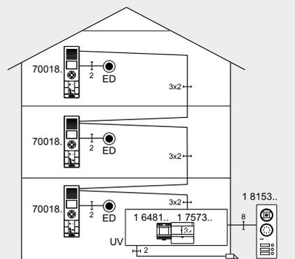
Bei der Inbetriebnahme wird jeder Video-Freisprechstelle ein Klingeltaster eingelernt. So kann jede Wohneinheit separat von der Haupteingangstür aus angewählt werden. Dabei wird die Videoverbindung automatisch aufgebaut. Wenn keine Berechtigung für manuelles Einschalten vorliegt, kann keine weitere Video-Freisprechstelle die Bildverbindung aufbauen (Mithör- und Mitschperre).
