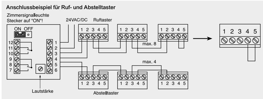
Die Ruftasterleitung muss mittels einer Drahtbrücke über die Anschlüsse 4 und 5 des letzten Ruftasters abgeschlossen werden!
