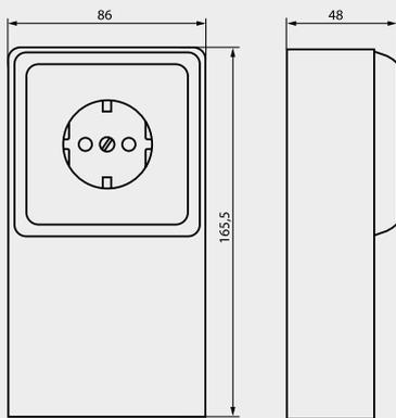
Geräteträger mit Schutzkontaktsteckdose und Schachtauslass, 2-fach
