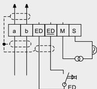
M/S = Anschluss eines bauseitigen Alarmgebers
