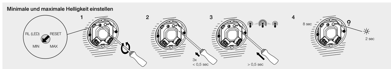
Dimmermodul ist ausgeschaltet und Leitungsschutzschalter ist eingeschaltet. (Arbeiten unter Spannung!)
