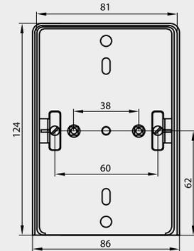
Geräteträger mit Schutzkontaktsteckdose und Schachtauslass, 1-fach
