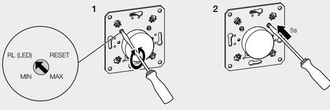
Die Werkseinstellung des Dimmers ist der RC-Modus. Der Dimmer erkennt die angeschlossene Last automatisch, allerdings kann es bei einigen Lampen zu Funktionsstörungen führen (siehe Herstellerangaben). In diesem Fall können Sie die Betriebsart umstellen.
