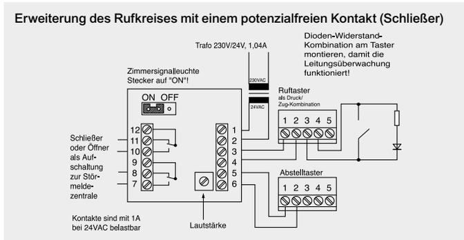
Mit Taster 122110 kann mit einer Leuchtmarkierungsbaugruppe 123230 oder 123140 über die Kontakte 10 und 11 bzw. 7 und 8 der Zimmersignalleuchte ein „Beruhigungslicht“ realisiert werden.
