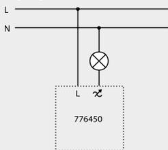
UP-Kombigerät mit elektronischem Schaltausgang, Art. 776400
