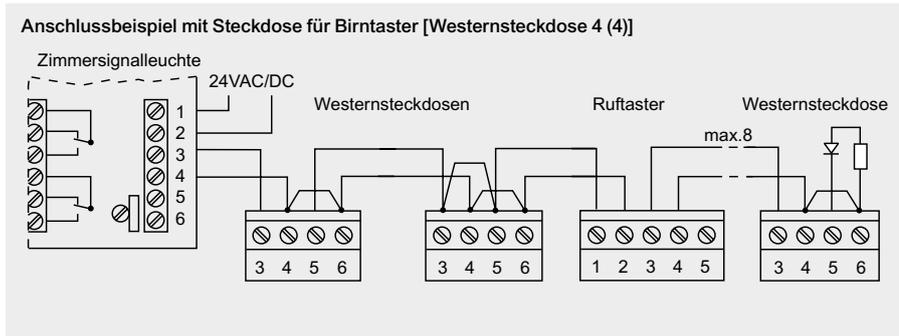
Westernsteckdosen und Ruftaster sind in einer Rufleitung kombinierbar. Besteht der letzte Ruftaster aus einer Westernsteckdose, dann wird die Rufleitung mit einer Widerstand-Dioden-Kombination abgeschlossen.
