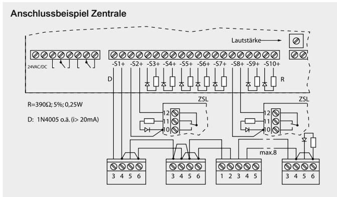
An die Eingänge der Zentrale (S1 bis S10) müssen entweder ein Rufaster, eine Zimmersignalleuchte (ZSL) oder eine Widerstand-Dioden-Kombination angeschlossen werden.
